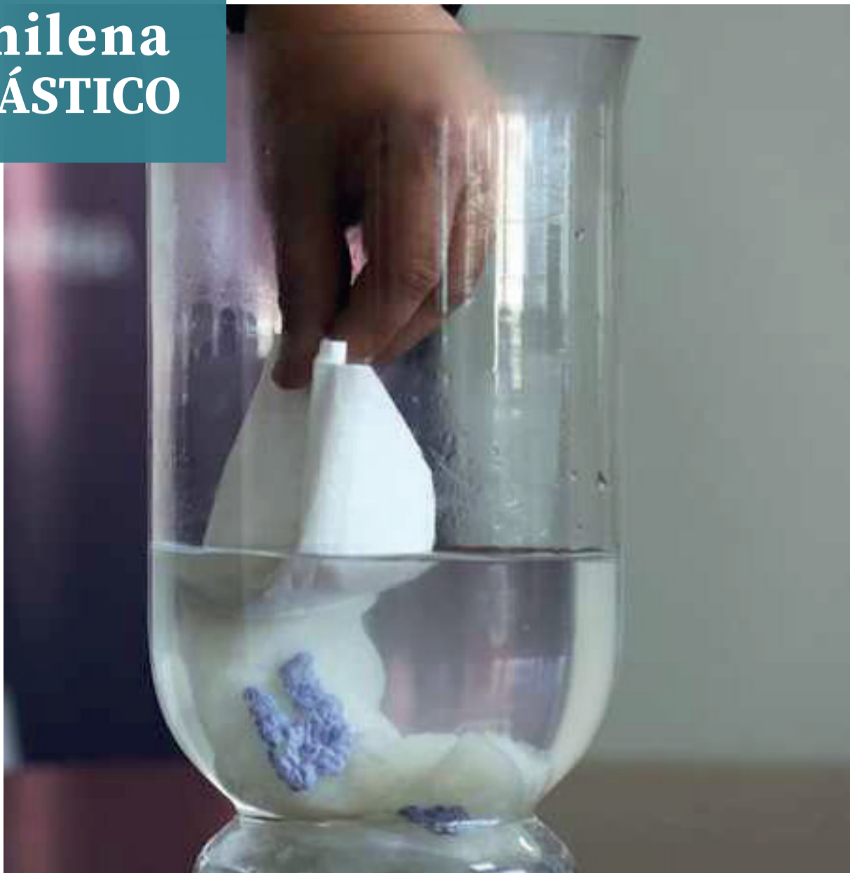
En agua fría, la bolsa demora 5 minutos en disolverse, mientras que en agua caliente o salada la reacción es inmediata.
