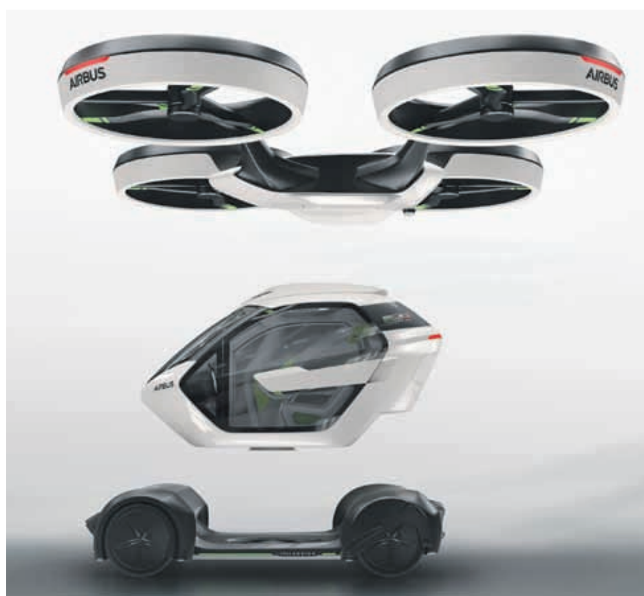
Imagen del Pop.Up y sus partes modulares tanto para carretera como para el aire.
