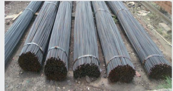
Son varas de acero provistas con agarraderas, corrugas o deformaciones en la superficie de la barra, que minimizan la posibilidad de que se resbale el concreto e incrementa la adherencia entre los dos materiales. Pueden utilizarse sin ganchos en los extremos.
