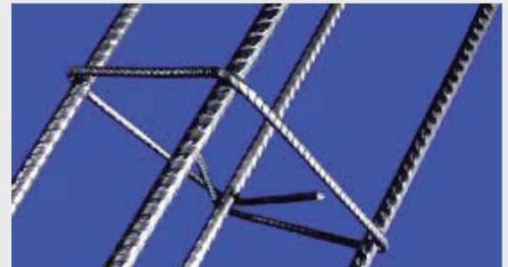
Son armaduras prefabricadas a partir de barras de acero de alta resistencia, constituidas por cuatro barras longitudinales principales de diámetro 8,0 o 9,2 mm, confinadas mediante estribos transversales electrosoldados en todos los puntos de encuentro, de diámetro 4,0 o 4,2 mm y espaciados cada 15 centímetros.
