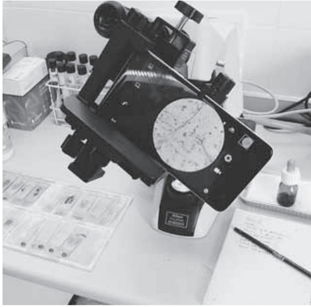
Imagen real de un análisis a través del móvil adaptado a un microscopio. La base del juego para encontrar bacilos.
