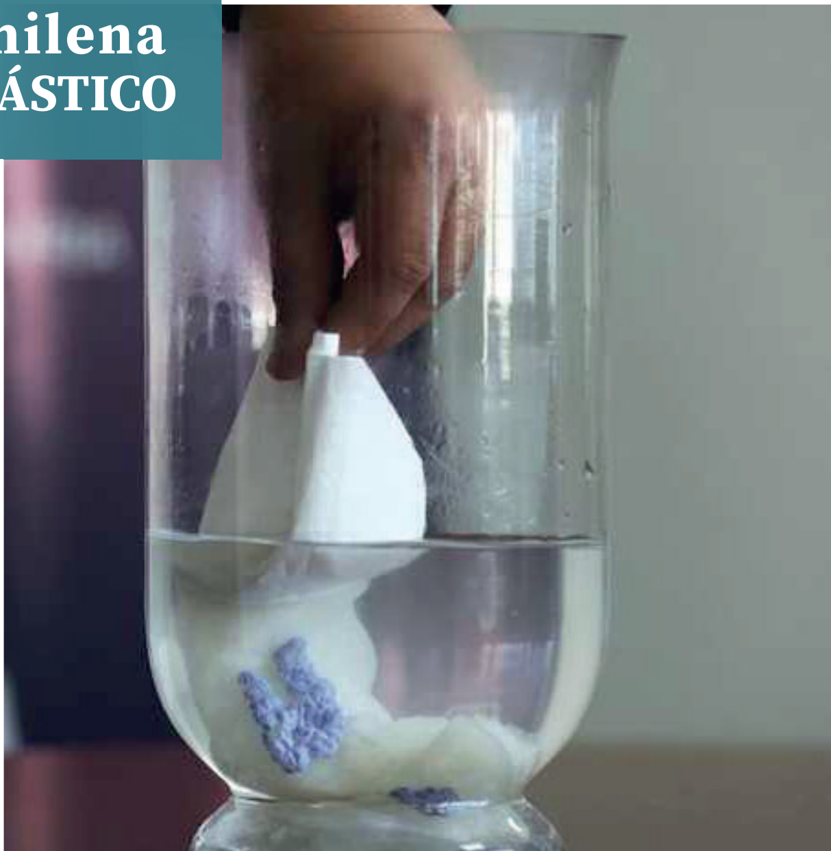
En agua fría, la bolsa demora 5 minutos en disolverse, mientras que en agua caliente o salada la reacción es inmediata.
